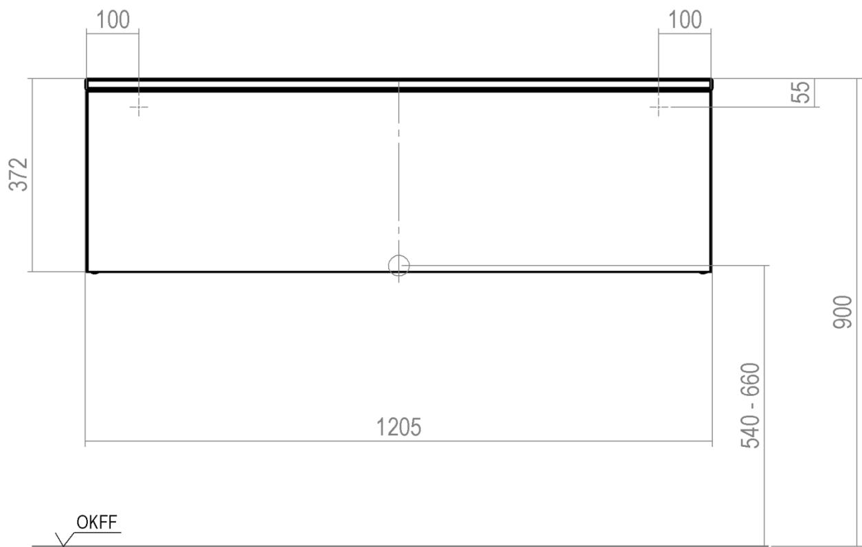
\*OKFF = Oberkante Fertigfußboden / Finished Floor Level (FFL)
