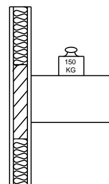
Por parte del propietario debe garantizarse un refuerzo de pared suficiente.
